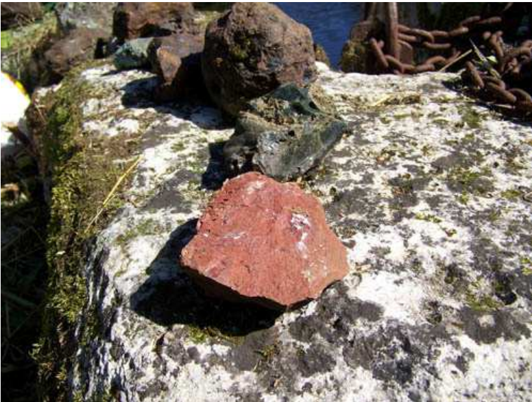
Devant, minerai de fer. Derrière, scories (résidus de la production de fer dans un bas fourneau) Photo prise au Cluzeau.
